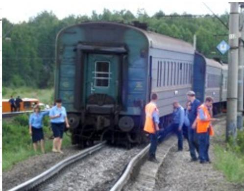
В результате деформации из-за теплового расширения поезд сошел с рельсов.
