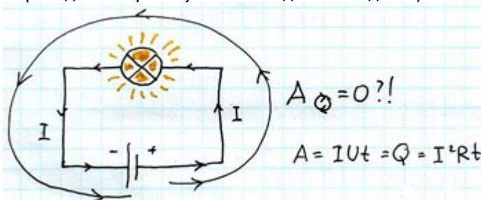
**Замкнутая электрическая цепь** в обязательном порядке содержит источник тока и потребитель, в данном случае - батарейка и лампочка.
