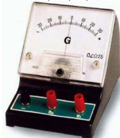
Этот прибор имеет нулевую отметку в середине шкалы. При протекании тока стрелка отклоняется вправо или влево от нуля в зависимости от направления тока. Гальванометр с катушкой образуют так называемый **замкнутый контур**, который *не содержит источника тока*.
